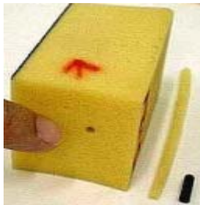
左:ウレタンフォーム貫通加工例、 中央:プラグ、右: 4mm飛翔体
